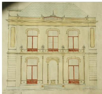
Afb. 22. Tekening van de noordelijke en zuidelijke gevel met verschillende attieken. De oostelijke gevel (rechts), de achtergevel, heeft geen attiek.
